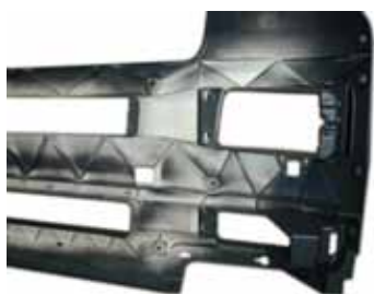
Fig. 2a: Paraurti originale MAN, vista posteriore
