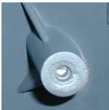
Fig. 3b: Foro senza rinforzo sul ricambio di imitazione
